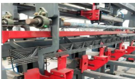
钢筋桁架焊接生产线
