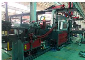
钢筋桁架焊接生产线
