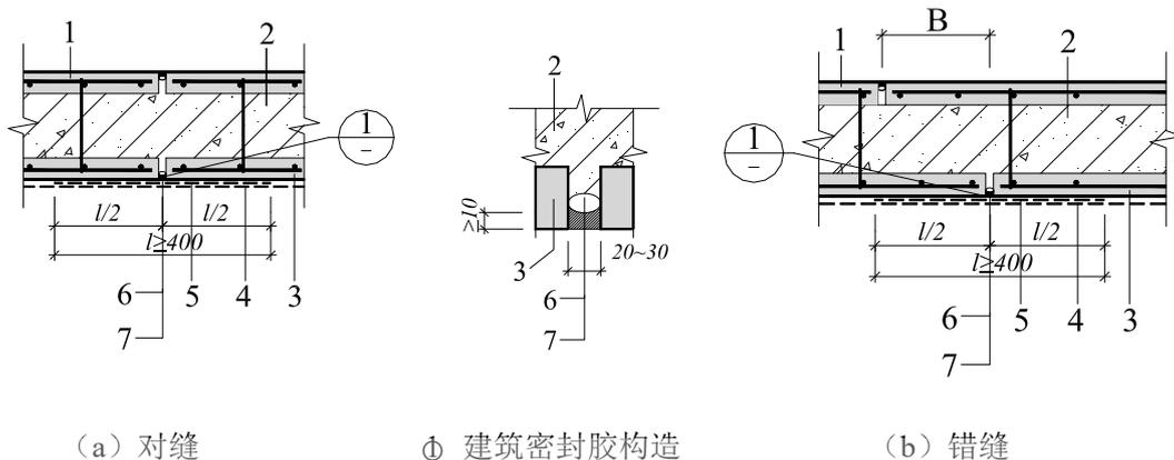
图 4.3.3 地下工程叠合外墙接缝构造
