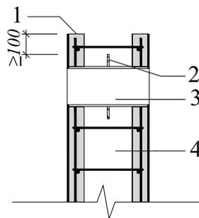
图 4.3.9 预制空腔墙构件预埋刚性防水套管
