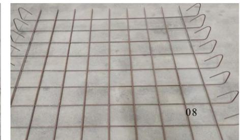
产 能 平均每张网片/笼节拍约2.5min 按规格3300×4500mm，横筋间距100mm测算
