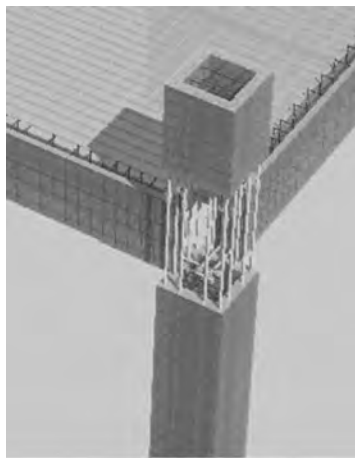
图 2-6 混凝土叠合结构节点示意
