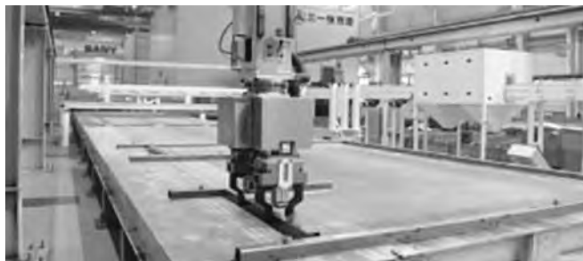
图 4-1 自动拆（布）模机器人安装不锈钢磁性边模
