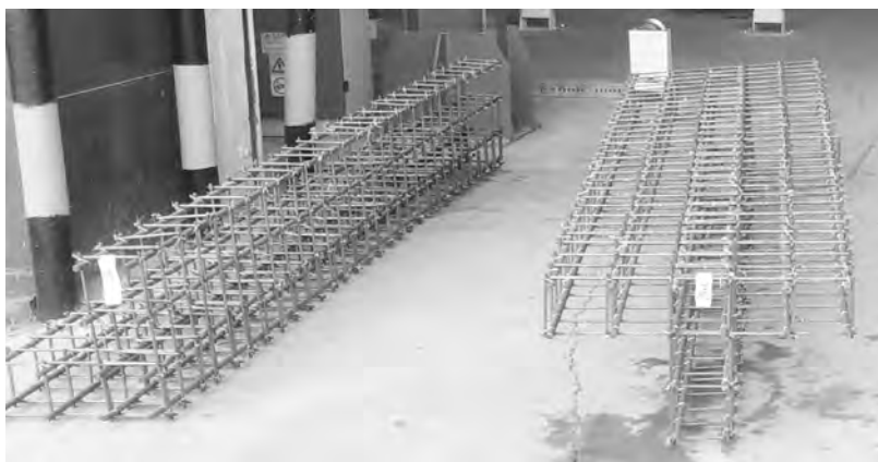
图 2-14 工厂生产的成型钢筋笼
