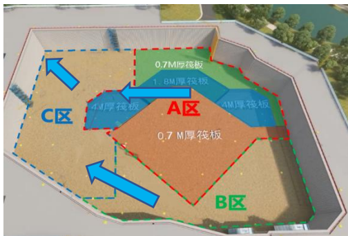
土方开挖分区及路线
