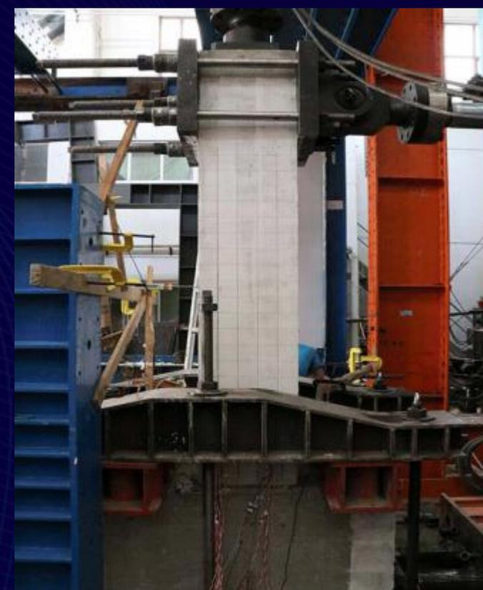
🏠 构件受力、破坏模态与现浇构件一致，具有与现浇结构一致的抗震性能
