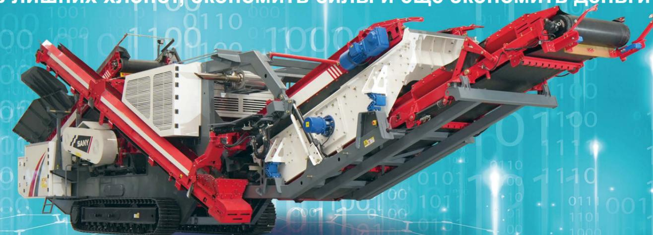
Используются для вторичного и третичного дробления и рекуперации твердых материалов с прочностью на сжатие до 300Мпа в строительной, транспортной, железнодорожной, цементной, строительных материалов, металлургической, хвостовой и других отраслях промышленности.
