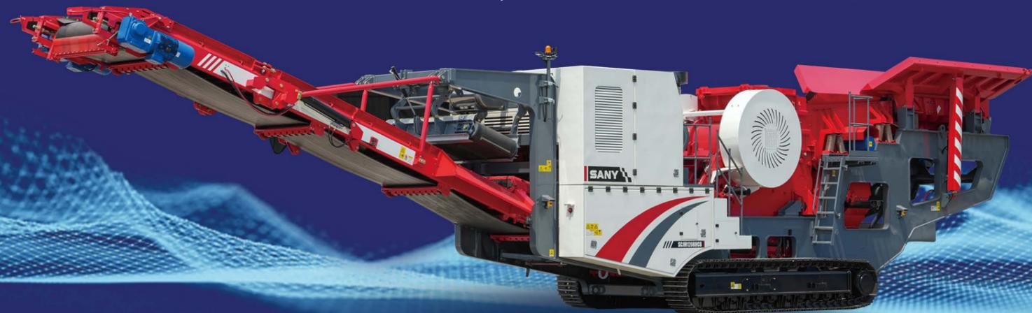
Используются для первичного дробления и рекуперации твердых материалов с прочностью на сжатие до 300Мпа в строительной, транспортной, железнодорожной, цементной, строительных материалов, металлургической, хвостовой и других отраслях промышленности.
