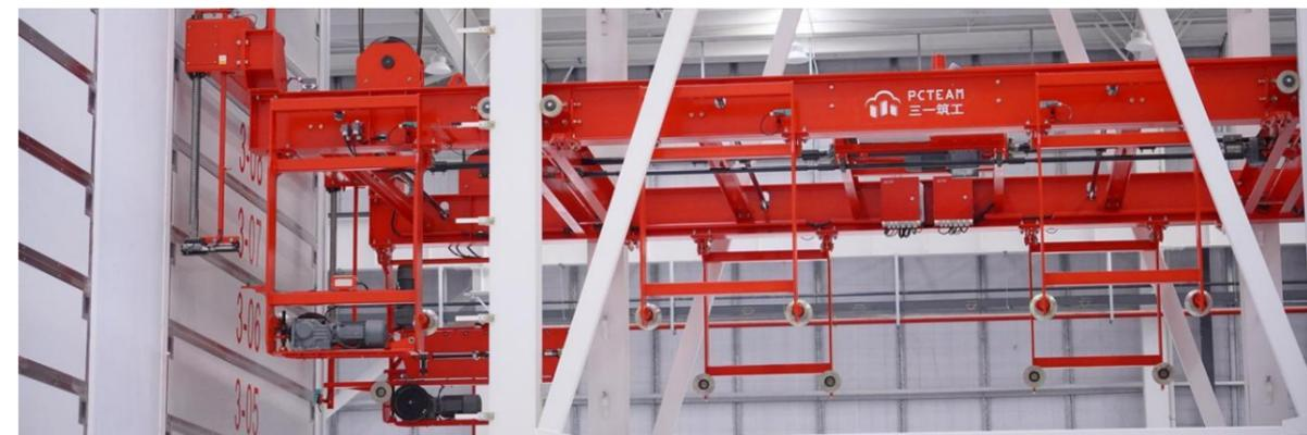
**Штабелёр:** Штабелёр обладает функцией полностью автоматического хранения и удаления поддонов. Для точного позиционирования используется технология серво- и рейково-шестерённого привода для бокового перемещения тележки. Подъём тележки использует технологию синхронизации подъёмного оборудования для механического позиционирования по высоте. Взаимодействие с системой PMS позволяет автоматическое назначение позиций ячеек.
