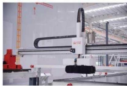
6 Машина для маркировки и смазки
