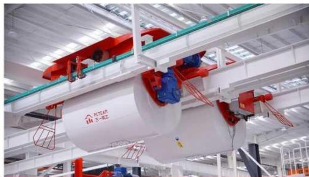
Высокоскоростной конвейер для бетона
