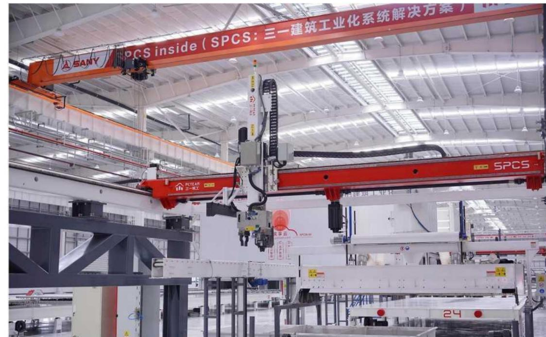
**Многофункциональный робот для обмана:** Первый робот в области ПС для демонтажа/формования, который интегрирует функции демонтажа/формования, транспортировки и очистки краевых форм, очистки пресс-платформы, нанесения рисунка, формования и управления складом краевых форм. Он значительно улучшает операционную эффективность и качество продукции, снижает количество рабочих и трудозатраты, а также делает значительный шаг вперед в области интеллектуального оборудования для ПС.
