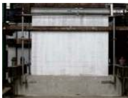
剪力墙结构构件实验
